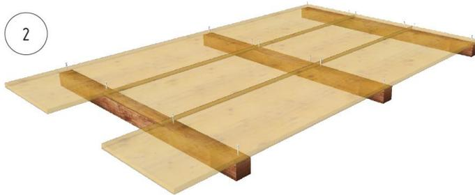
3x Konterlatten (60x80mm) mit den Schalungstafeln verschrauben (ca. 18-20 Schrauben)
